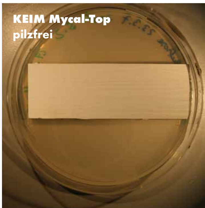
Lagerung von Anstrich in Nährboden – ohne aktive „Beimpfung“ mit Pilzsporen
